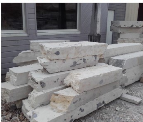
Photographie 1 : Pierre de Vernon débitée
